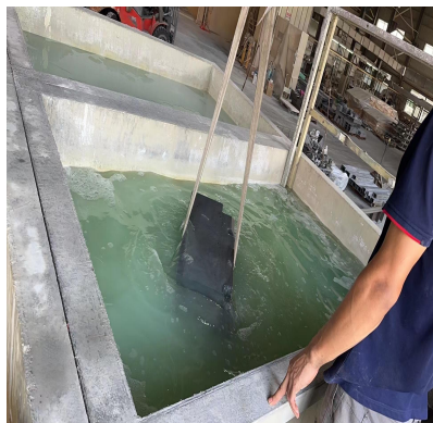
水洗 钣金件酸洗磷化工艺
