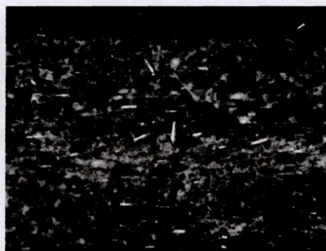
图 2 普通玻纤材料物理微发泡产品断面
