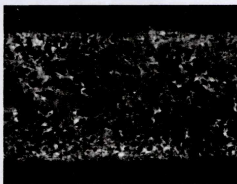
图 3 物理微发泡微开模注塑成型产品断面
