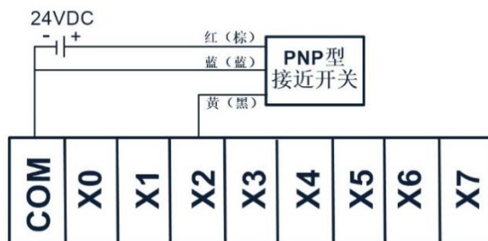
三线制（PNP 型）接近开关接线图示例
