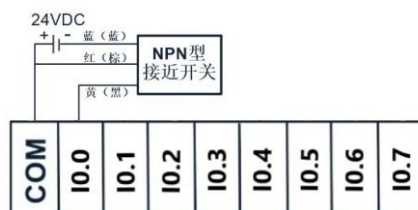
三线制（NPN 型）接近开关接线图示例
