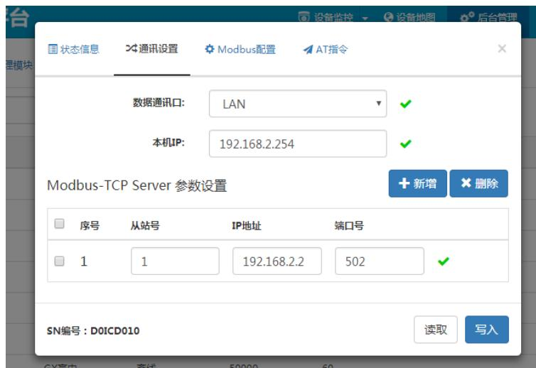
**数据通讯口：**设置为与 PLC 通讯口类型，可选 RS485、RS232 或 LAN 网口，此处使用 LAN 网口进行 MODBUS-TCP 通讯；
